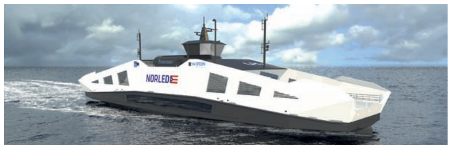
Eine der beiden sich im Bau befindenden Doppelendfähren wird durch Batterien betrieben, die andere durch eine Kombination aus Batterien und Brennstoffzellen. Quelle: LMG Marin
